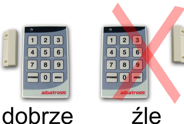
Rysunek 11. Przykład dobrze i źle zamontowanego czujnika otwarcia drzwi. Przykład „źle” gdyż odległość pomiędzy klawiaturą a czujką otwarcia drzwi jest większa niż 10mm. Czujnik można montować z jednej lub drugiej strony klawiatury.
