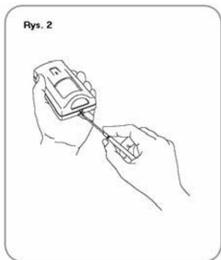
Rysunek 25. Demontaż przedniej części obudowy
