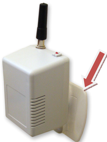
Rysunek 8. Zamontowane urządzenie w gniazdku z napięciem ~230V 50Hz
