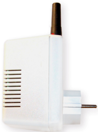
Rysunek 1. Centrala systemu z anteną GSM
