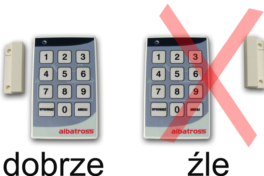
Rysunek 9. Przykład dobrze i źle zamontowanego czujnika otwarcia drzwi. Przykład „źle” gdyż odległość pomiędzy klawiaturą a czujką otwarcia drzwi jest większa niż 10mm.
